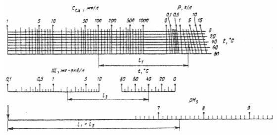
Рис. 1. Номограмма для определения pH насыщения воды карбонатом кальция (pH<sub>s</sub>)
